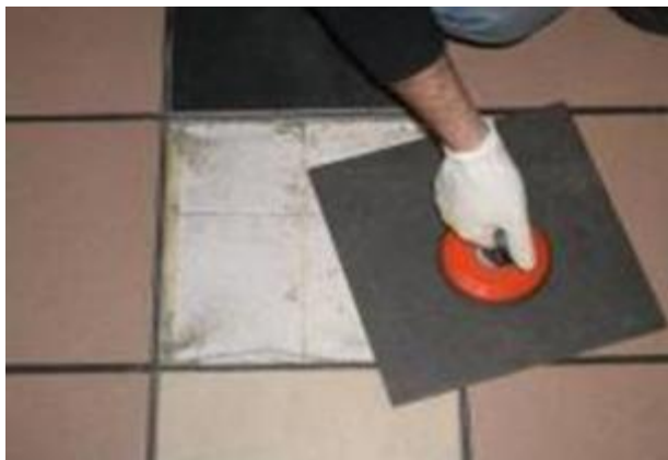
Figura 3. Retirada de las muestras para ser caracterizadas en el laboratorio
