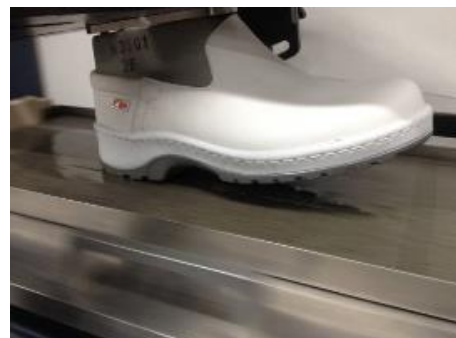
Ejemplos de detalles de los ensayos sobre pavimento con los contaminantes.
