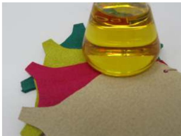
Figura 7: Pieles que incorporan microcápsulas mediante acabado con sistema roller
