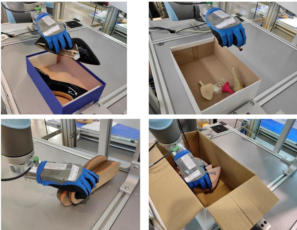
Fig. 16. Ejemplos de posicionamiento de diversos componentes de calzado
